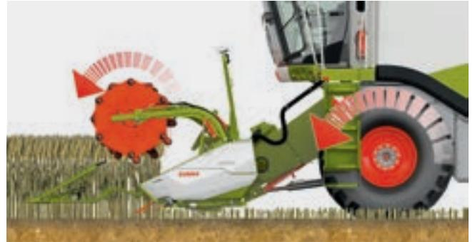
Grâce à une comparaison automatique des valeurs (valeur réelle/valeur de consigne), AUTO CONTOUR permet à la barre de coupe de suivre parfaitement le profil du terrain. Ce système facilite grandement le travail, notamment avec de grandes largeurs de coupe, de nuit, en dévers ou sur des sols caillouteux. Il permet d'augmenter nettement les performances et de rendre la nouvelle LEXION encore plus rentable.
