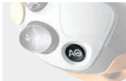
Il suffit d'appuyer sur la touche AUTO PILOT du levier CMOTION ou du levier multifonctions pour activer CEMOS AUTOMATIC.
