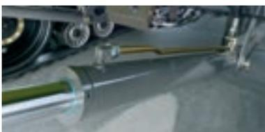
Seuls deux vérins se chargent de moduler avec précision la pression d'appui de la barre de coupe.
