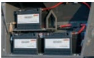
Deux batteries de 24 V pour la gestion moteur électronique et une batterie de 12 V pour le réseau de bord
